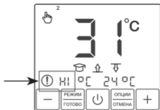
Рис. 18. Замыкание датчика обогрева
