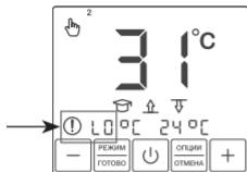
Рис. 17. Обрыв датчика обогрева
