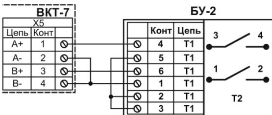
3.3 При подаче управляющего импульса на контакт 5 клеммной колодки Т1 – происходит замыкание контактов 3 и 4 выходного клеммника Т2. При подаче управляющего импульса на контакт 3 клеммной колодки Т1– происходит замыкание контактов 1 и 2
