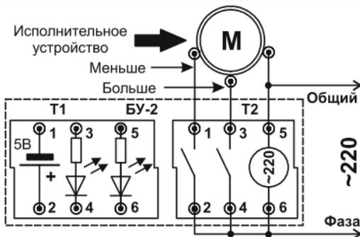
Вариант схемы подключения двух исполнительных устройств регуляторов через блоки БУ-2 к вычислителю ВКТ-5.
