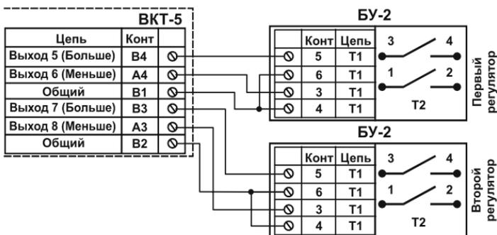
Вариант схемы подключения исполнительного устройства через блок БУ-2 к вычислителю ВКТ-7
