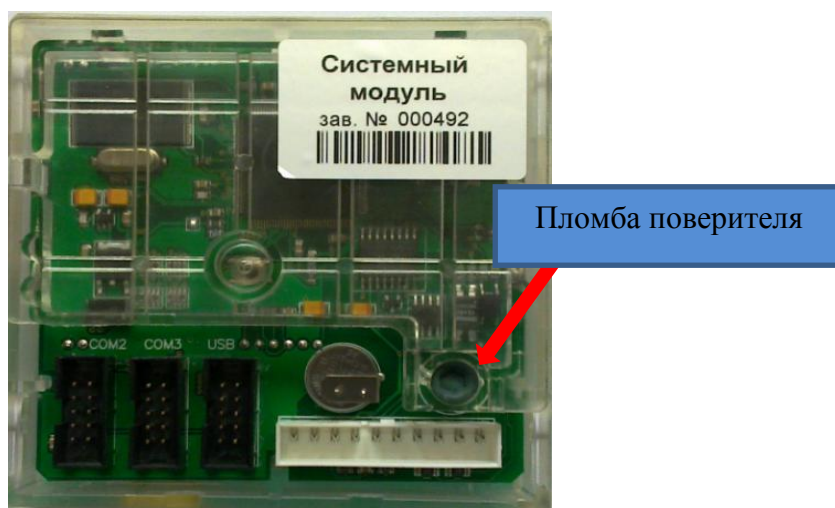
Рисунок 3 – Место пломбирования системного модуля
