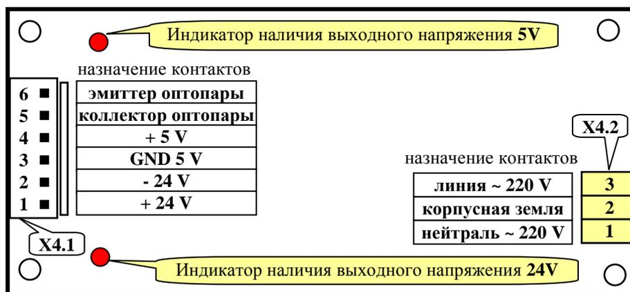
Рисунок А.2.1.4 - Плата БП (блока питания) контроллера
