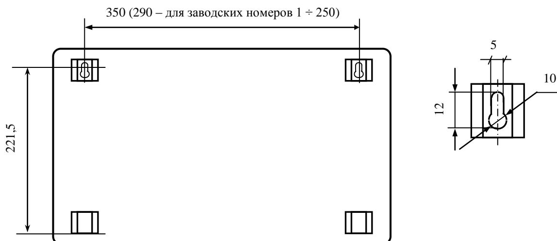
Рисунок 3.1.2 Установочные, присоединительные размеры (вид сзади)
