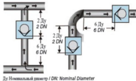
Турбулентный поток может привести к высоким нагрузкам на створке, в результате чего сокращается срок службы или клапан выходит из строя. После запуска системы убедитесь в отсутствии протечек в местах фланцевого присоединения. Обеспечьте достаточное пространство вокруг клапана для будущих работ по техническому обслуживанию.
