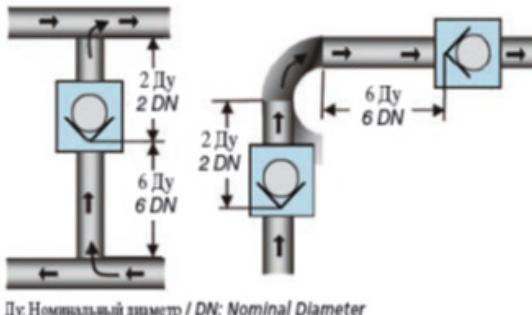
Турбулентный поток может привести к высоким нагрузкам на диске, в результате чего сокращается срок службы или клапан выходит из строя. После запуска системы убедитесь в отсутствии протечек в местах межфланцевого присоединения. Обеспечьте достаточное пространство вокруг клапана для будущих работ по техническому обслуживанию.
