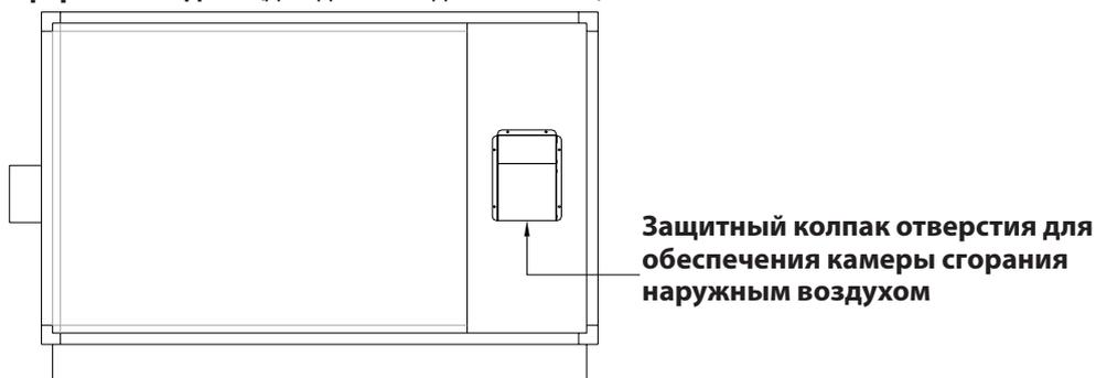
**Вывод для обеспечения камеры сгорания циркулирующим воздухом (пригоден для подключения всасывания внутри помещения циркулирующего воздуха )**
