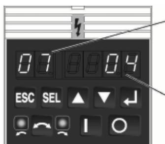
При возникновении неисправности, отображается P07- (Текущая неисправность)
