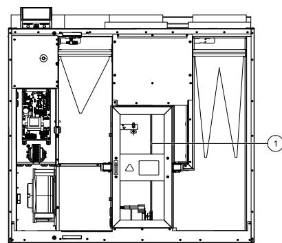
Рис. 6 Приводной ремень ротора
