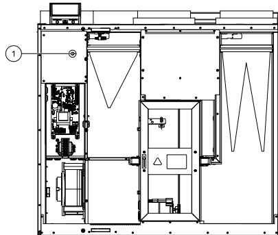
Рис. 7 Кнопка сброса защиты от перегрева
