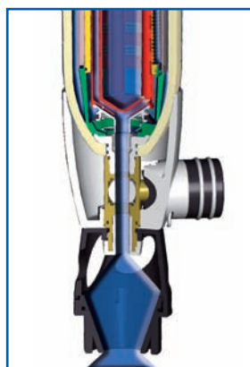
Процесс обратной промывки.
