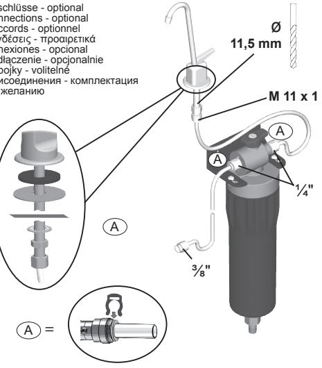
Schlauchanschluss / Hose connection / Raccord de tuyau flexible / Σύνδεση εύκαμπτου σωλήνα / Empalme de manguera/ Przyłączenie dla węża / Hadicová přípojka / Подключение шланга
