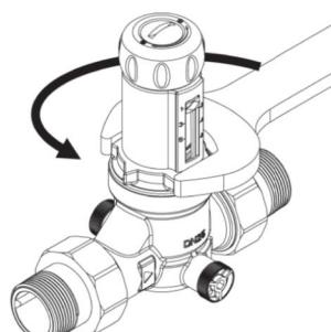
Промойте картридж чистой холодной водой. Затем снова заверните картридж на корпус.
