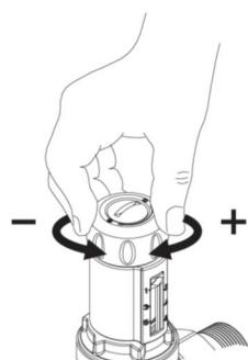
Когда давление установлено, снова зафиксируйте редуктор давления путем поворота предохранительного по часовой стрелке.
