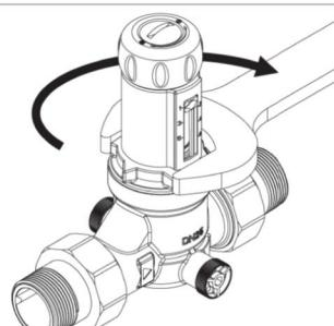
Откройте воду с помощью запорной арматуры. Затем проверьте герметичность оборудования и правильность показателя давления.
