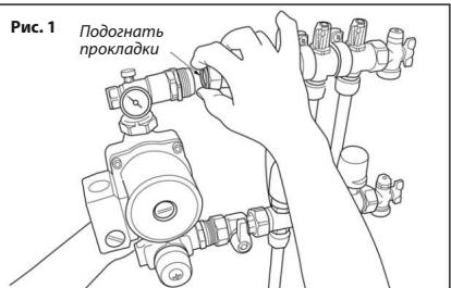
Подвести узел к соединениям, разместив сначала нижнее (*обратное*) соединение (рис. 1), затем повернуть верхнее (*подающее*) соединение до параллельного выравнивания и протолкнуть весь узел вперед до момента, когда накидные гайки дойдут до резьбы.
