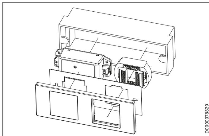
Устройство управления, блок питания и пульт управления монтируются вместе в двойную розетку скрытого монтажа.
