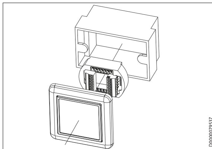
Устройство управления и пульт управления устанавливаются в розетку скрытого монтажа. Блок питания устанавливается на DIN-рейку на распределительном щитке. Блок питания занимает до четырех мест автоматических выключателей.
