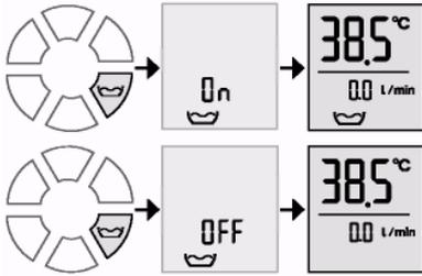
Автоматический водомер включен ⇒ на индикации высвечивается символ
