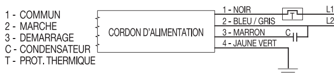
Schéma de branchement électrique IMMERGEES MONOPHASEES SEM-PRM-CUTTY
