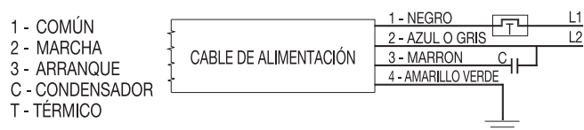
Esquema de conexión eléctrica SUMERGIBLES MONOFÁSICA SEM-PRM-CUTTY
