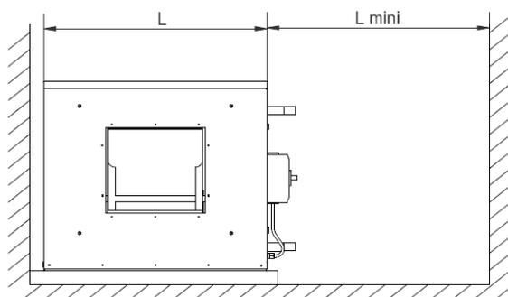
Установка должна размещаться на горизонтальной опоре. Рекомендуется использовать антивибрационные опоры, а также гибкие вставки для присоединения установки к воздуховодам.
