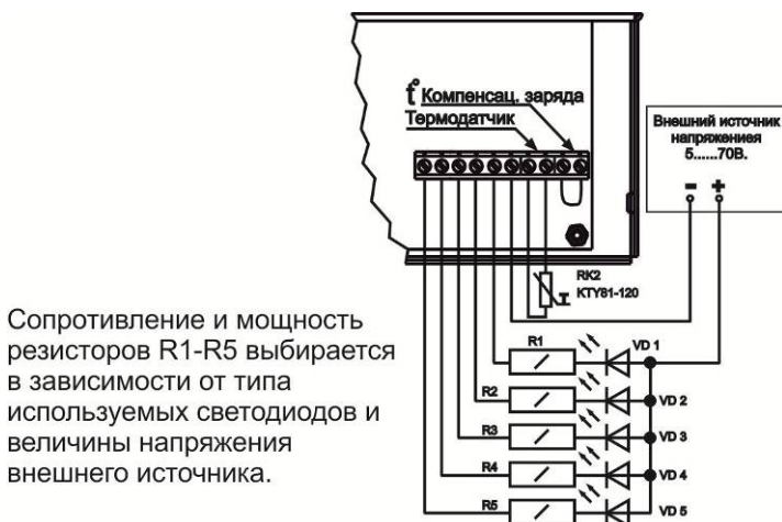
Рисунок 7 – подключение внешних цепей индикации
