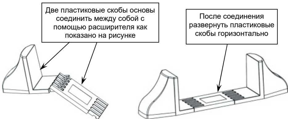
Рисунок 3 - Сборка пластиковых основ и расширителя для вертикальной установки изделия с ИБП.
