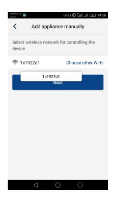
5. Устройство на базе OC Android: в ходе следующего шага введите локальную сеть Wi-Fi, к которой Вы хотите подключить устройство. Введите пароль и продолжите настройку.
