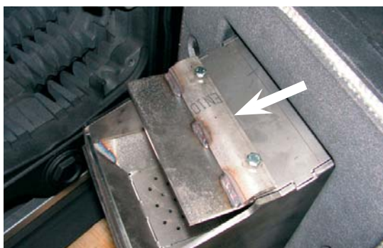
Рис. 13.12: Установка дефлектора пламени
