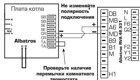
– Соединение контроллера "RVA 46.531" и комнатного устройства QAA70: соединение между комнатным устройством и блоком RVA 46.531 осуществляется как показано на схеме.
