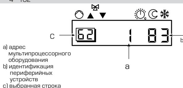
Блок RVA46.531 контура 1 соединен с бойлерной платой котла, которая соответствует №102 и с комнатным устройством QAA70, которое соответствует №83.
