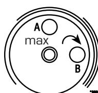
– Переключатель режимов работы котла, устанавливается в положение "Remote", чтобы сделать возможным дистанционное управление котлом посредством контроллера RVA 46.531. В этой программе установочные данные кнопок: "Riscaldamento" (отопление) и "Sanitario" (ГВС) не являются важными.
