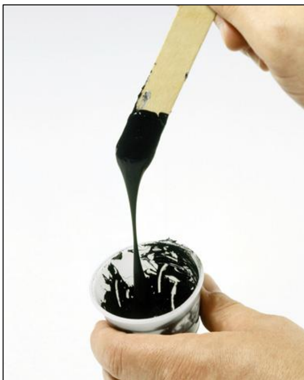
Рис. 8: Материал имеет пастообразную форму: время жизнеспособности смеси не закончилось
