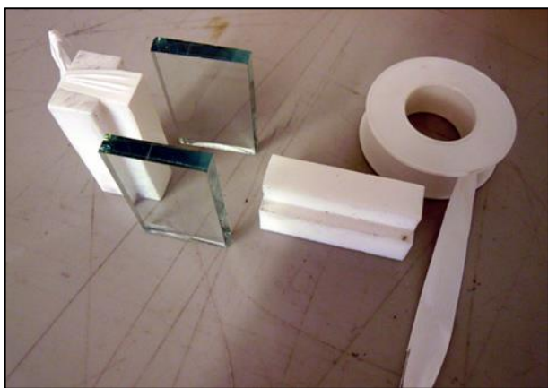
Рис. 16: Рекомендуемый набор для тестирования однокомпонентных материалов и образцы поверхностей (стекло): тефлоновые формы (PTFE), пластиковая лента (PTFE) для однокомпонентных клеев
