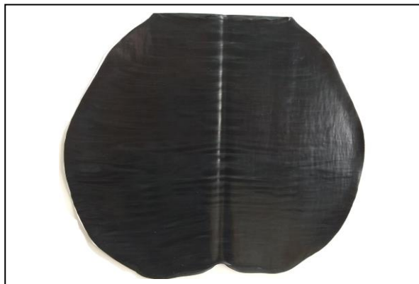
Рис. 7: Тест не пройден= не однородная смесь
