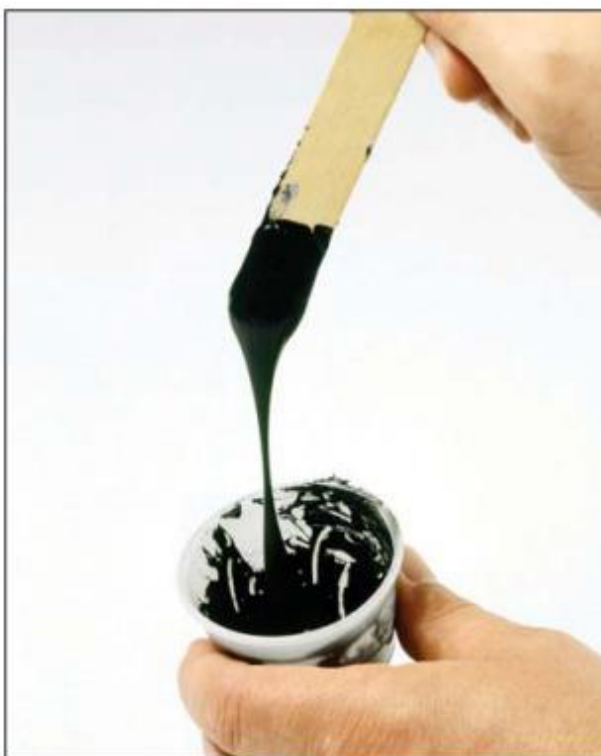
Рис. 10: Материал имеет пастообразную форму: время жизнеспособности смеси не закончилось
