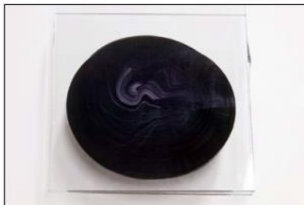
Рис. 7: Тест не пройден=не однородная смесь
