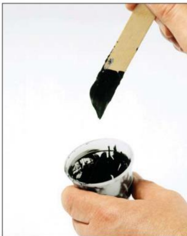
Рис. 11: Материал рвется, сразу после поднятия шпателя: время жизнеспособности смеси закончилось
