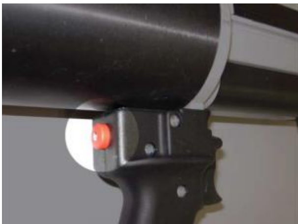
Рис. 1: Кнопка возврата поршня
