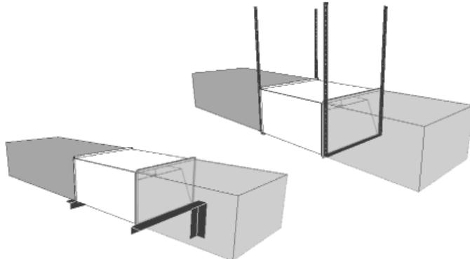
Если вес вентилятора снижает прочность системы воздуховодов, необходимо дополнительно прикрепить вентилятор к полу, стене или потолку.
