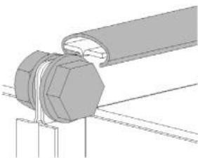
К воздуховодам вентилятор монтируется болтами и С-профилем.
