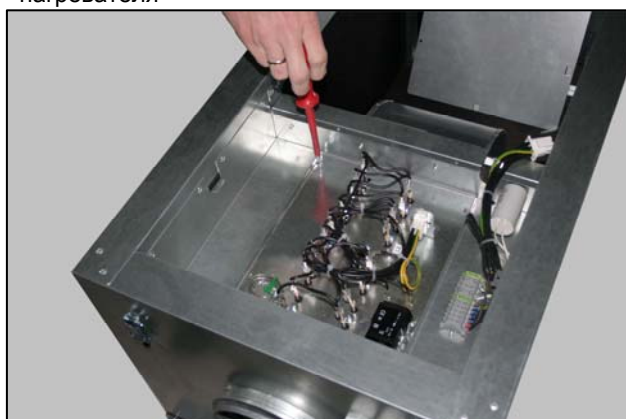
4. Зафиксируйте нагреватель с помощью саморезов
