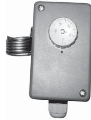
Индустриальный одноступенчатый настенный термостат ET060/HY с переключающимися контактами используется для контроля поддерживаемой в помещении температуры. Применяется в системах обогрева, охлаждения и кондиционирования воздуха в условиях сильной загрязненности (запыленности и влажности) и в химически агрессивной атмосфере, в торговых и производственных помещениях, спортзалах, складах и гаражах, машинных залах, теплицах, сельскохозяйственных сооружениях и т. д.
