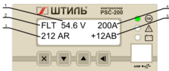
Рисунок А2 - Основной режим отображения состояния системы
