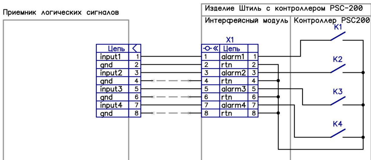
Рисунок 2.2. Пример схемы подключения сигнализации Установленное по умолчанию назначение контактов разъема СИГНАЛИЗАЦИЯ приведено в таблице 2.2.
