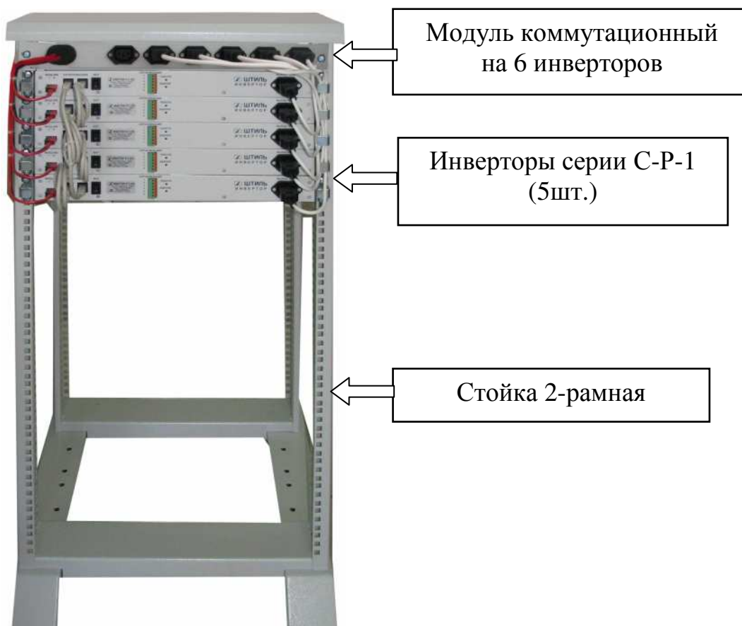
Рисунок 1.6 - Инверторная система мощностью 3 кВт (по схеме N+1 ) с использованием модуля коммутационного для 6 инверторов
