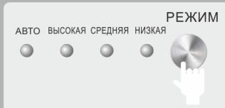
С помощью кнопки “ РЕЖИМ” задать соответствующую скорость работы прибора (цикл: средняя скорость, высокая скорость, автоматический режим и низкая скорость).
