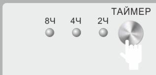
Нажать клавишу “ ТАЙМЕР” для установки временного режима (цикл: 2 часа, 4 часа, 8 часов).
