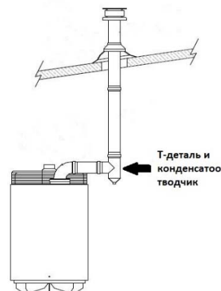
Рисунок 9.1.1 Возможные варианты дымоходов - горизонтальный через стену, вертикальный через крышу
