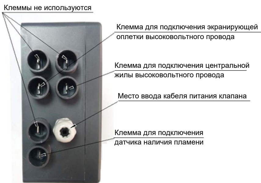
Рисунок 4.3.3 Инфраконтроль IC 3501. Подключение кабелей
