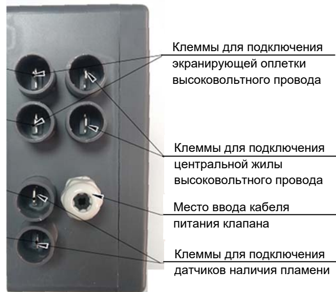
Рисунок 4.3.2 Инфраконтроль IC 3502. Подключение кабелей
