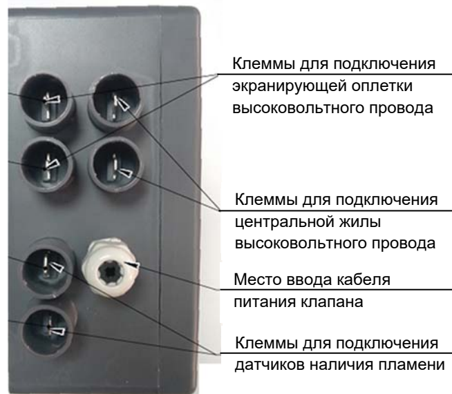
Рисунок 4.3.2 Инфраконтроль IC 3502. Подключение кабелей
