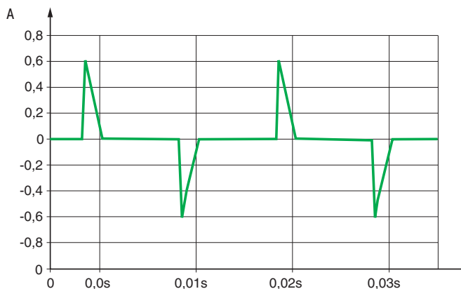
Рис. М7. Типовая форма кривой тока компактной люминесцентной лампы
