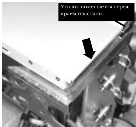
2 Опустить аппарат и установить его на опорные пластины
