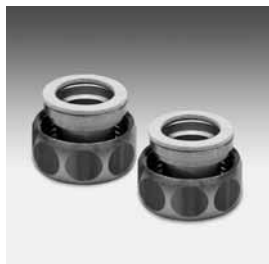
Katalog-Nr. und -bezeichnung 970 – Pumpenanschlussverschraubung für Pressverbindungen aus Rotguss, DVGW geprüft, für Heizungs- und Brauchwasserpumpen, je ein Set besteht aus: 2 Einlegteilen aus Rotguss mit SANHA-Pressprofil, 2 Überwurfmuttern aus Messing, 2 AFM 34-Dichtungen (WS 3820) bis 200 °C, DVGW geprüft (asbestfrei)
