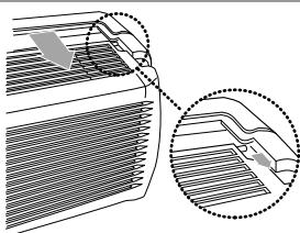
Чтобы получить наилучшие результаты при эксплуатации вашего кондиционера, вы должны регулярно чистить его для удаления пыли, скапливающейся на воздушном фильтре.
