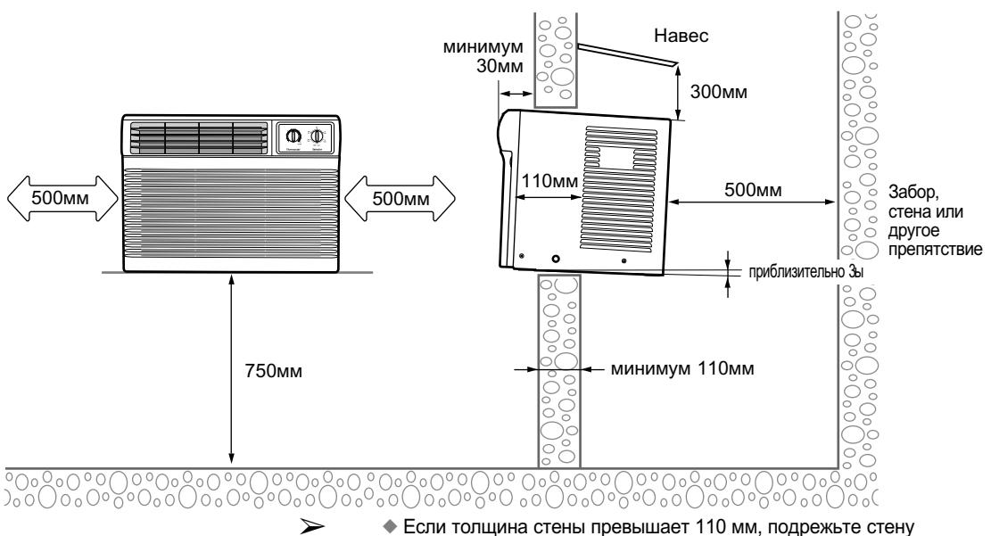
► ◆ Если толщина стены превышает 110 мм, подрежьте стену сзади под углом 45°, если это возможно.
