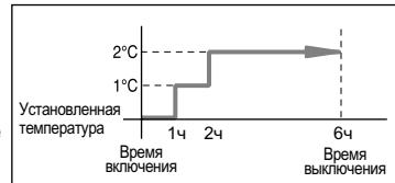
Обогрев Установленная температура понижается на 1°C в час. Когда она понизилась на 2°C (через два часа), температура поддерживается на этом уровне в течение четырех часов.
