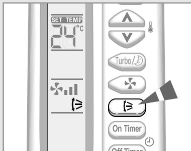
*В зависимости от расположения комнатного блока на стене вашей комнаты, вы можете отрегулировать положение расположенной на нижней поверхности блока наружной пластины, регулирующей воздушный поток, увеличив тем самым эффективность работы вашего кондиционера.*
