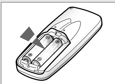
1 Толкните крышку отсека для батареи на нижней поверхности пульта большим пальцем в направлении, указанном стрелкой и снимите ее.
