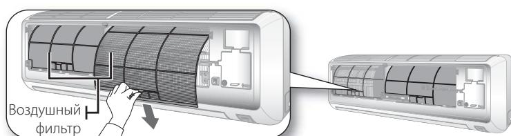
3. Вычистите воздушный фильтр пылесосом или мягкой щеткой. Если запыление фильтра значительное, промойте его проточной водой и просушите на воздухе.
