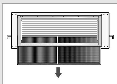
1 Снимите фиксирующий держатель на основании комплекта воздушного фильтра.
