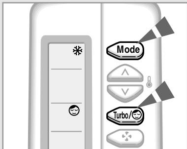
**Таймер "сон" может использоваться при охлаждении вашей комнаты для того, чтобы кондиционер автоматически выключался по истечении шести часов.**
