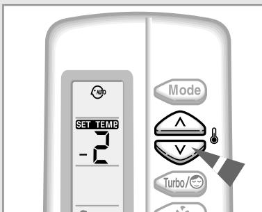
Вы можете включить кондиционер в автоматическом режиме с пульта дистанционного управления. В автоматическом режиме работы автоматически выбираются стандартная температура и оптимальная скорость вентилятора. Вы можете изменить стандартную температуру, но не можете изменить скорость вентилятора.
