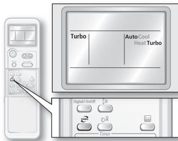
Функция «Turbo» доступна только в режимах Авто/Охлаждение/Обогрев. Если функция «Turbo» была выбрана в режиме Удаление влаги/Вентиляция, кондиционер переходит в режим Авто.
