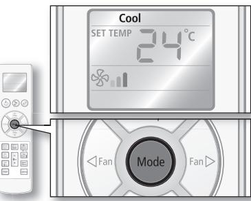
Каждый раз вы нажмите кнопку **Mode**, режим будет изменен в следующие типы: Auto (Авто), Cool (Охлаждение), Dry (Влагопоглощение), Fan (Вентилятор) и Heat (Обогрев).
