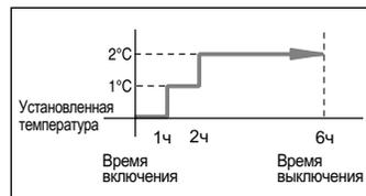
**Обогрев** Установленная температура понижается на 1°C в час. Когда она понизилась на 2°C (через 2 часа), температура поддерживается на этом уровне в течение четырех часов.
