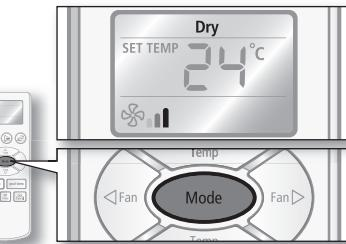
Каждый раз вы нажмите кнопку **Mode**, режим будет изменен в следующие типы: Auto (Авто), Cool (Охлаждение), Dry (Влагопоглощение), Fan (Вентилятор) и Heat (Обогрев).
