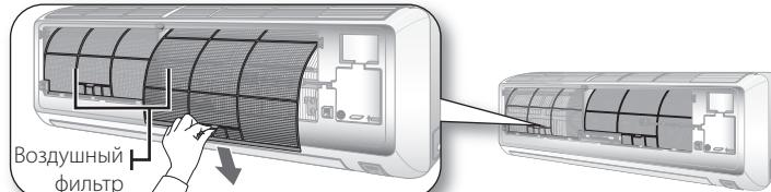
3. Вычистите воздушный фильтр пылесосом или мягкой щеткой. Если запыление фильтра значительное, промойте его проточной водой и просушите на воздухе.
