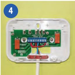
4 Подсоедините провода к приемнику по одной из схем на страницах 4 и 5
