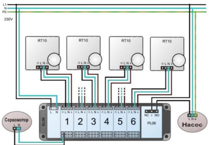
Каждая секция подключение к 4 сервомоторам
